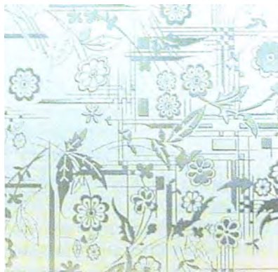
Рис. 44. Этот рисунок на стекле появился в результате реакции с плавиковой кислотой
